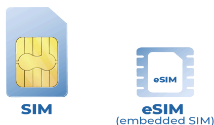
Figure 2 - SIM versus eSIM
